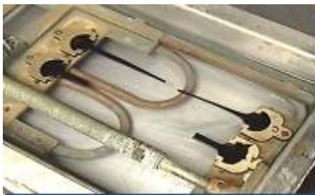
Prueba de recuperación elástica en ductilómetro, a 25 °C
