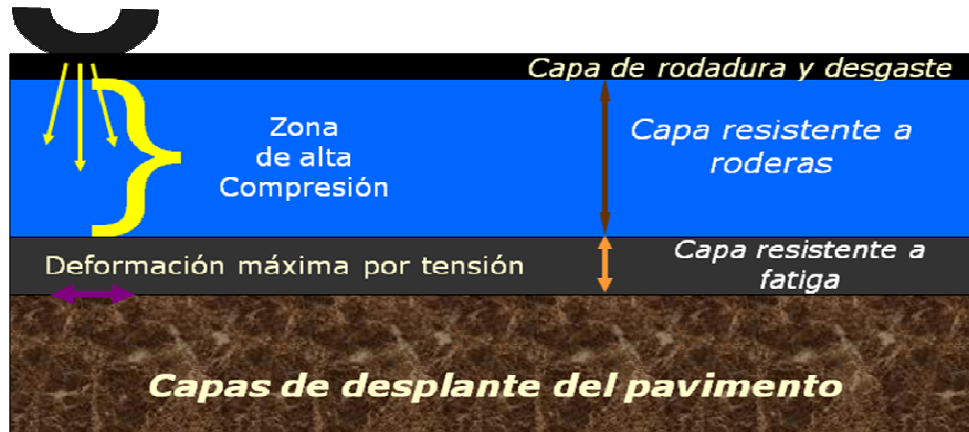
Figura 1. Estructura de un pavimento de larga duración.
